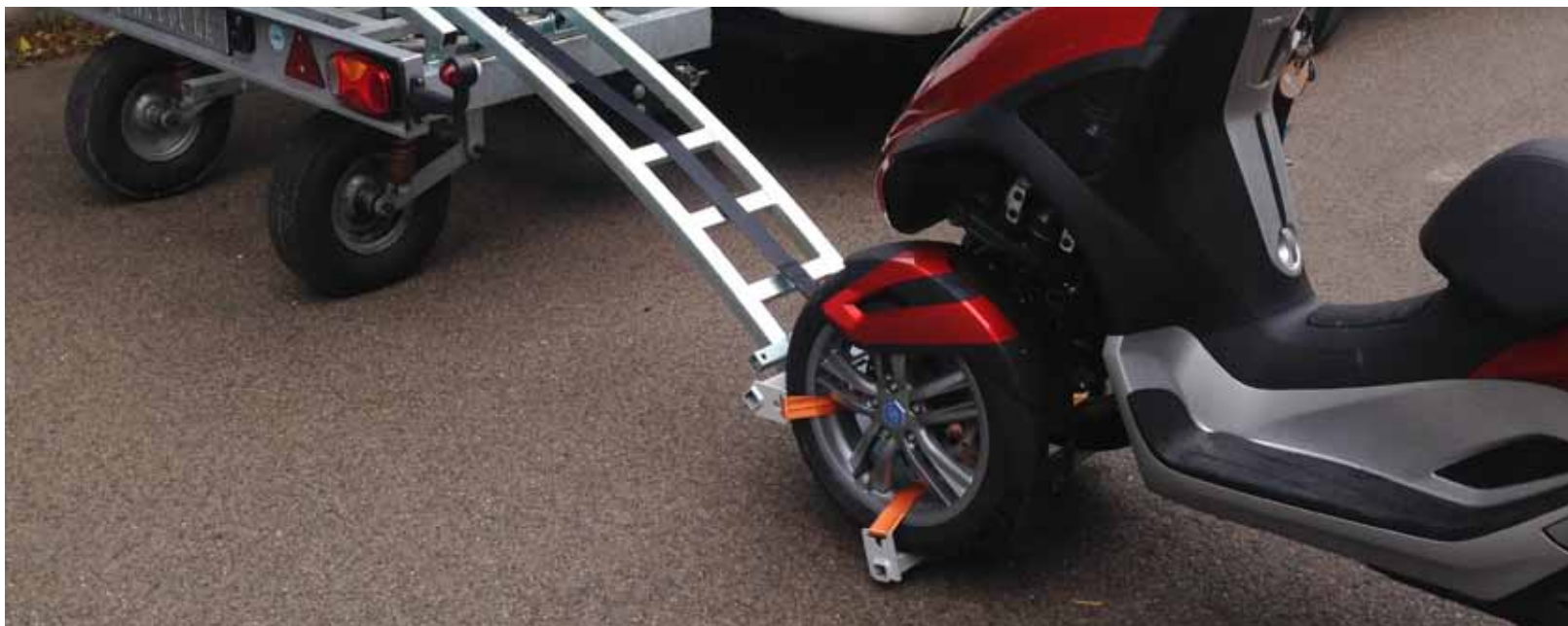
Le sabot équipé d'un adaptateur pour les scooters à trois roues.
